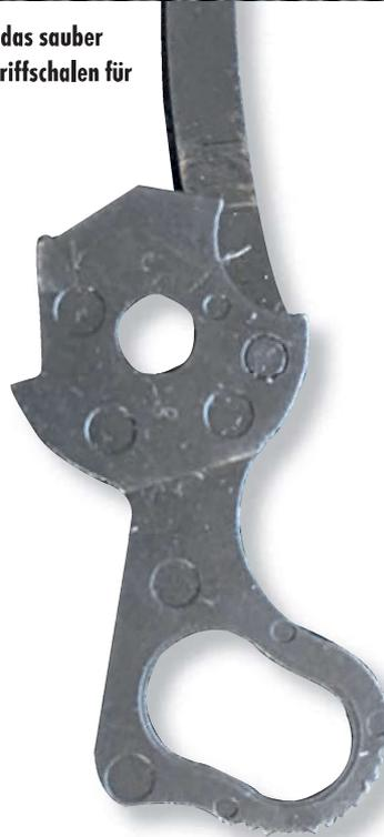
**Sparkurs:** Gerade bei preisgünstigen Waffen kommen oftmals rationelle Fertigungsmethoden wie etwa Feinguss- oder MIM-Technik zum Einsatz, was sich gut an den runden, produktionsbedingten Ausstoßmarken an den Kleinbauteilen erkennen lässt.
